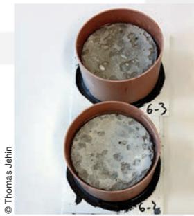
Résultats des essais gel-dégel avec agent de déverglçage. Au bout de 28 jours, l'échantillon de référence M0 (sans granulat recyclé) présente une perte de masse de 0,72 kg/m<sup>2</sup> (échantillon carotté du haut) ou de 0,43 kg/m<sup>2</sup> (carotte du bas).
