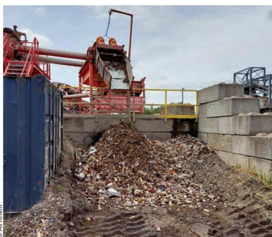
Tas de déchets flottants retirés des déchets inertes après traitement par voie humide (Recymex Saint-Ghislain).
