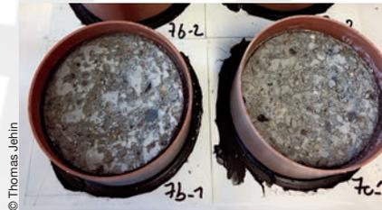
Résultats des essais gel-dégel avec agent de déverglçage. Au bout de 28 jours, les échantillons de granulats de béton concassé de type A M50-75CC et M25-40CC présentent une perte de masse respective de 1,27 kg/m<sup>2</sup> (à gauche) et de 2,15 kg/m<sup>2</sup> (à droite).
