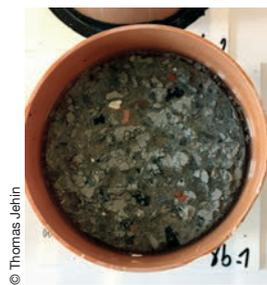
Résultats des essais gel-dégel avec agent de déverglçage. Au bout de 28 jours, l'échantillon de granulats mixtes de type B M50-75MA présente une perte de masse de 1,96 kg/m<sup>2</sup>.
